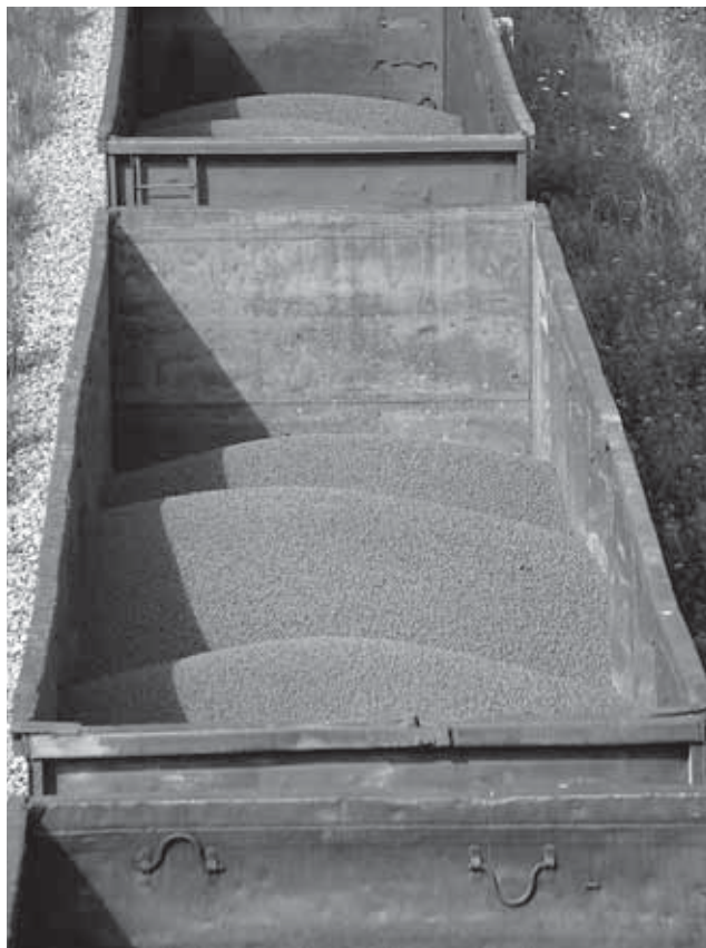
Zdj. 2/3. Ruda żelaza w drodze do Huty Katowice. Jest przesyłana zarówno w postaci sypkiej, jak i skoncentrowanej (granulat). Ciężar właściwy rudy pozwala załadować nią tylko połowę wagonu, aby nie przekroczyć dopuszczalnych nacisków na osie. Przededworze, 10 sierpnia 2004 r. Fot. T. Ciemnoczułowski
